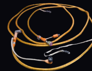
1965年米国発の宇宙遊泳アンビリカルケーブル 「ゴールデン・アンビリカル」
