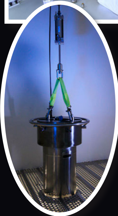
大型圧力容器: ケーブルハーネスや コネクタ、顧客支給のサブアッセンブリ までも試験ができるように設計
